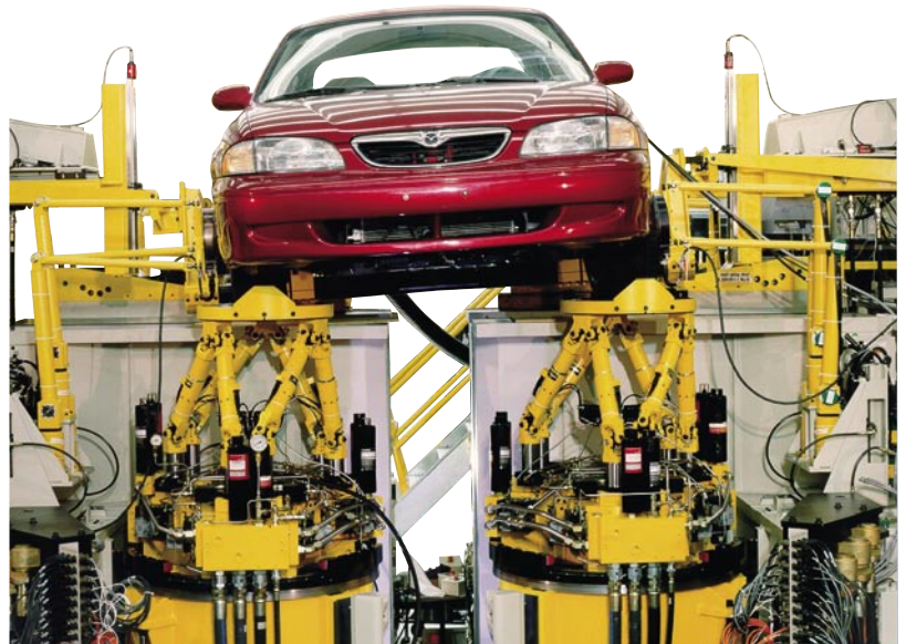
▲ POC により有効性が確認された MDV コンセプトは、動的キネマティクス/コンプライアンスなどをテストする他の MTS テストベンチに適用されます。
